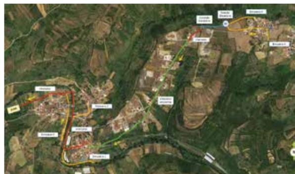
A Tejo Atlântico arrancou com a execução do sistema de drenagem e transporte do Carvalhal, no município de Mafra, através da construção de cinco emissários, um intercetor e um sistema elevatório. Este sistema vai possibilitar que as águas residuais produzidas sejam encaminhadas para a futura Fábrica de Água do Carvalhal.
