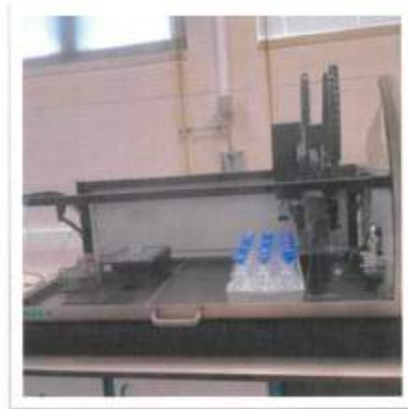
Figura 20 - Sistema de robotização para realização do ensaio de CBOD5
